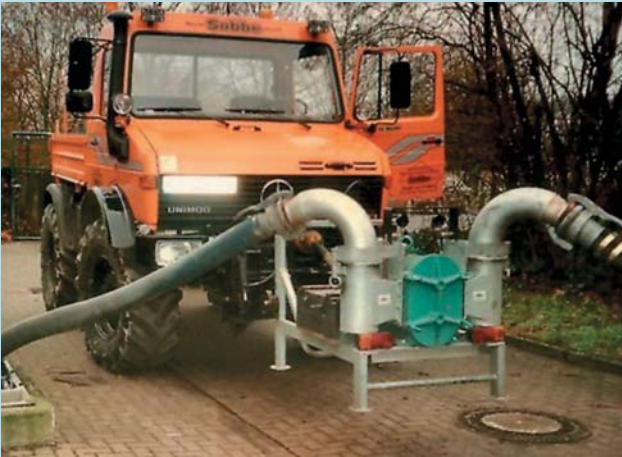
Arbeitsmaschine mit Nebenantrieb sind oft vorhanden, hier eine selbstansaugende Drehkolbenpumpe als Anbau an einem Unimog. Große Fördermenge mit niedrigem Invest.
