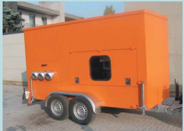
Universell einsetzbares Mobilaggregat, Antrieb über Dieselmotor, stufenlose Drehzahlverstellung ergibt Fördermengenanpassung für den jeweiligen Bedarf. Auf Kundenwunsch mit festnetz-unabhängigem Meldesystem.
